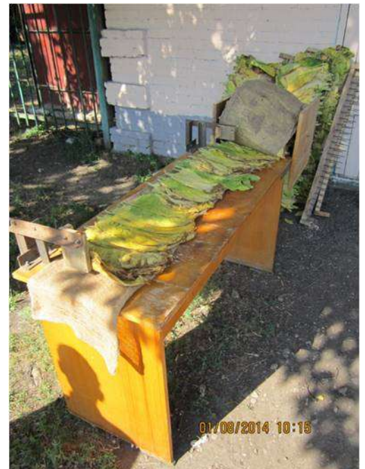
Рис. 2. Установка для нанизывания табачных листьев на иглы кассеты из накопителя рулонного типа в работе (момент начала прокола листьев)
